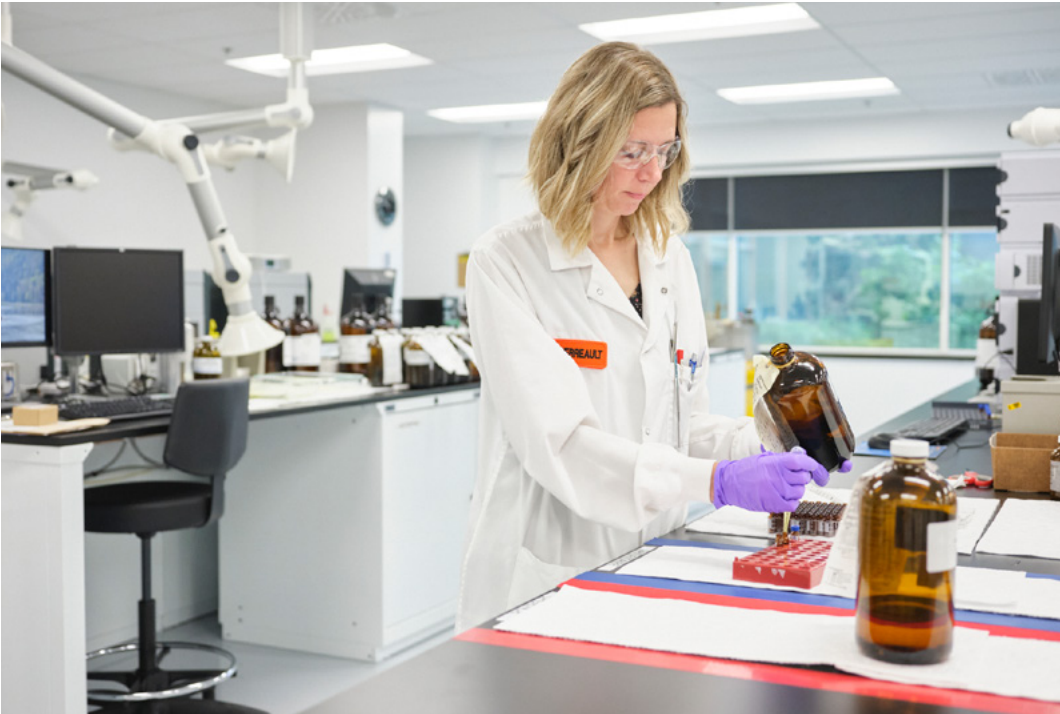
Joanie Perreault, technicienne – Chimie, laboratoire et radioprotection, s'apprête à analyser des échantillons d'huile qui proviennent d'un poste de transport d'électricité.
